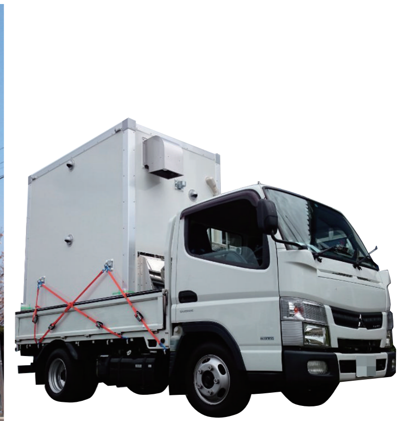
アルミサンドイッチパネル局舎(車載観測用) W2500×D1800
